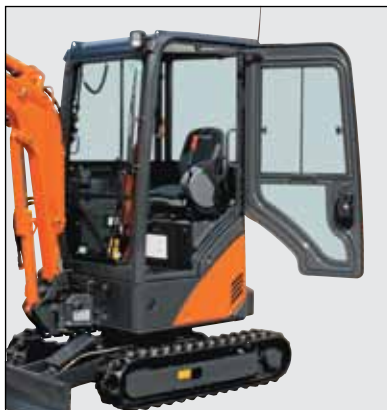
Układ blokady przy otwarciu drzwi (maszyny wyposażone w kabinę)
