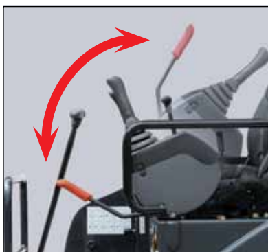
Dźwignia blokady umożliwia neutralny rozruch silnika
